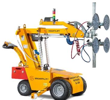
*SL 309 Outdoor : le plus petit et compact des robots de pose pour l'extérieur !*
